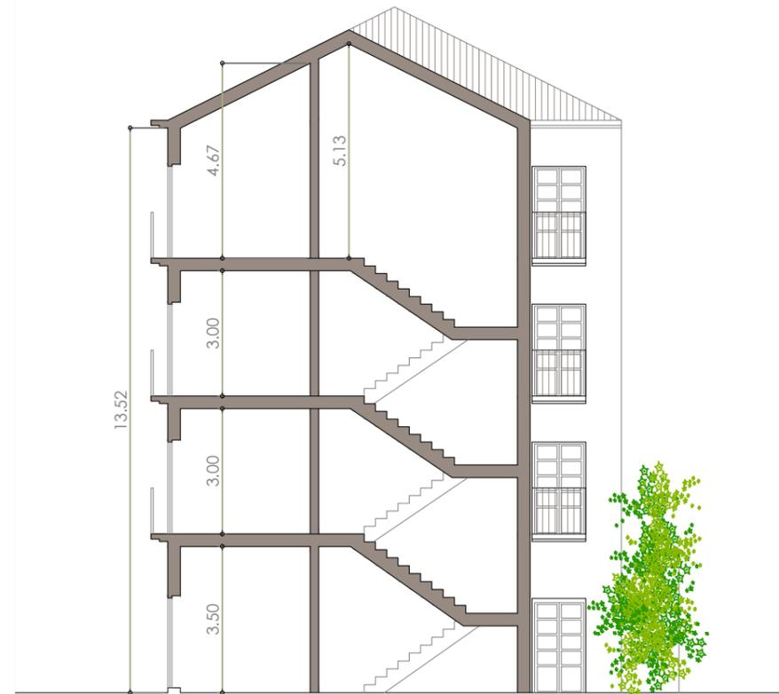
Sección tipo por núcleo de comunicación vertical
