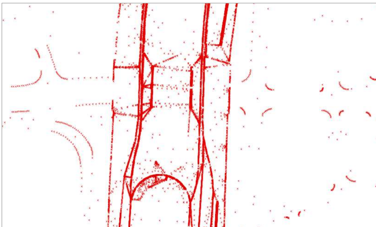
Imagen 5: Extracto de la nube de puntos utilizada para zona del cauce del estado actual. Fuente: EMASA
